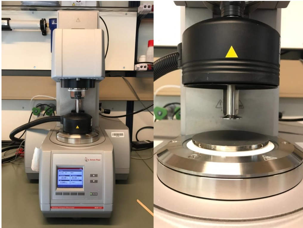
Abbildung 7: Anton Paar Modular Compact Rheometer zur Untersuchung der viskoelastischen Eigenschaften der Hydrogele unter variierender Zellzahl an hCh und Konzentrationen der Vernetzungsreagenzien HRP und \text{H}_2\text{O}_2 .
