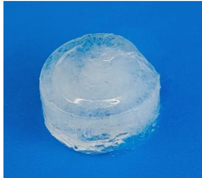
Abbildung 6: Seidenfibroin-HA-Tyr-Hydrogel Hybridscaffold. Durchmesser etwa 8 mm, Höhe etwa 4 mm.
